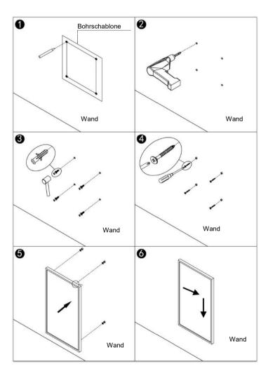
Schritt 1. Messen Sie den Abstand zwischen den Löchern der Bohrschablone und markieren Sie die Position an der Wand. Nehmen Sie eine Wasserwaage zur Hand um eine gerade Ausrichtung zu erreichen
